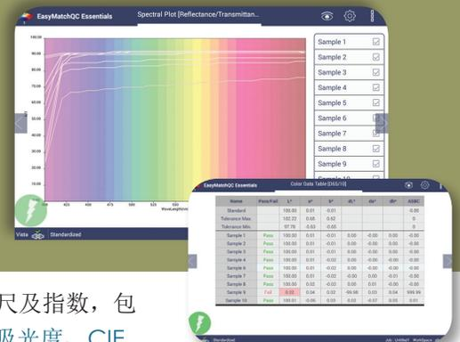
内置多项特色如定制的工作模板、数据图、与透射色及雾度相关的颜色和雾度标尺及指数，包括Pt-Co/Hazen/APHA, Gardner 颜色、雾度 %、乳白光、Y 透射、赛波特、吸光度、CIE 光谱数据及美国、欧盟和日本 3 大重要药典：
